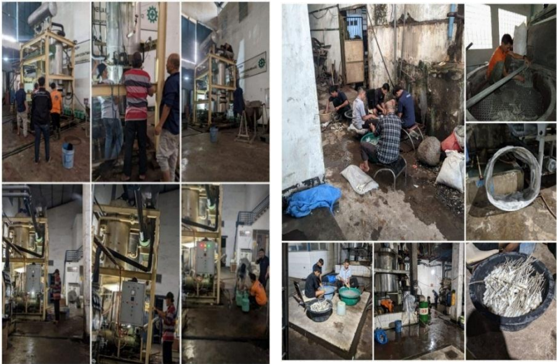
April 2025 Perbaikan Kebocoran Es tube 15ton dan pembersihan nozzle es tube 50 ton
