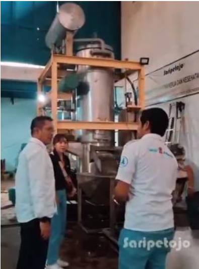
12 Maret 2025 Running test mesin es tube di Pabrik Es Saripetojo Bandung! Proses uji coba mesin es tube eks saripetojo bogor untuk memastikan kualitas dan performa terbaik dalam produksi es.
